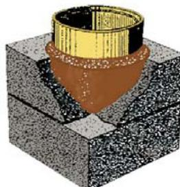
La Perlite trouve son application lors de construction ou rénovation de cheminée. La Perlite résiste à de très fortes températures grâce à sa nature incombustible, que se soit une cheminée en céramique, ronde ou carré, en métal, rigide ou flexible, etc.
