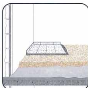
Płytki: ułożone na Thermo-Mix® Proporcje mieszanki zamieszczone na opakowaniu i na ulocie producenta np. 1+7.
