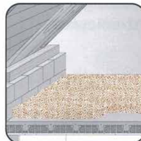
Mieszanka lekka położona na Thermo-Mix® 1:20
