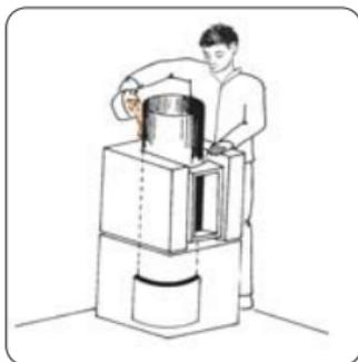
**Einfüllhöhe :** Abschnitte zu ca. 1 m (ca. drei Mantelsteine), bei Sanierung bis Kaminhöhe
