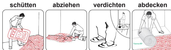
Vor dem Schütten Meterriss und Sollhöhe der fertigen Schüttung anzeichnen. Thermo-Floor® mit 20 % Überhöhung aufschütten, abziehen und durch direktes Begehen mit den Thermo-Verdichtungsschuhen (oder Handstampfer auf steifen Platten) verdichten. Kontrolle der Schüttungshöhe und Ebenheit. Überhöhen können jederzeit mit der Abziehle weggebracht werden, auf zu tiefe Stellen kann Thermo-Floor® zusätzlich aufgebracht und nochmals verdichtet werden.
