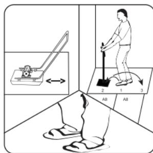
Vor dem Schütten Meterriss und Sollhöhe der fertigen Schüttung anzeichnen, Gefälle festlegen. Schütthöhen bis 30 cm werden in einem Arbeitsgang eingebracht. Darüber wird mehrschichtig gearbeitet, d.h. mehrmals **Thermo-Roof®** einbringen und verdichten.
