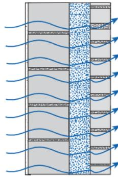
Bild 1d offene **Kerndämmung**
