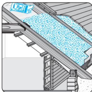
**Thermo-Fill®** zwischen die Polsterhölzer oder zwischen die Balken, etc. schütten, eventuell leicht verdichten. Kein Zuschnitt, kein Verschnitt, **Thermo-Fill®** passt immer. Sacköffnung tief halten, ruhige Sackführung - sie arbeiten mit einem sehr leichten Produkt!
