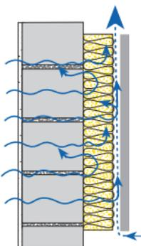
Bild 2a Fassade **hinterlüftet**
