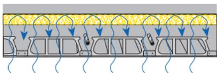
Bild 1a mit Dampfbremse
