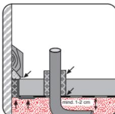
Schütthöhen bis 30 cm werden in einem Arbeitsgang eingebracht. Darüber wird mehrschichtig gearbeitet, d.h. mehrmals **Thermo-Floor®** einbringen und verdichten. Da **Thermo-Floor®** einen CP-Faktor von 0 hat, sind nahezu unbegrenzte Einbauhöhen möglich.
