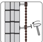
**stauss®-Fassadengewebe** aufziehen und Dübel schließen
