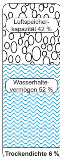
**Agroperl®** ist ein durch Hitze expandiertes Vulkangestein (dem Fensterglas eng verwandt) und besitzt viele Poren und Kapillaren.
