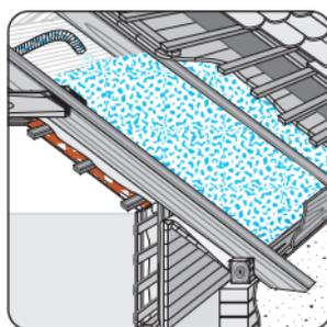
**Thermo-Fill® S oder S40** entweder die ca. 10 kg leichten Säcke mittels Thermo-Mat in die Hohlräume blasen oder bei großen Hohlräumen direkt mit dem Silo-LKW.
