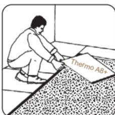
Vor dem Schütten Meterriss und Sollhöhe der fertigen Schüttung anzeichnen. Schütthöhen bis 30 cm werden in einem Arbeitsgang eingebracht. Darüber wird mehrschichtig gearbeitet, d.h. mehrmals Thermo-Plan® einbringen und verdichten. Da Thermo-Plan® einen CP-Faktor von 0 hat, sind nahezu unbegrenzte Einbauhöhen möglich.
