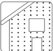
Anreißen, bohren und ca 5 Dübel / m<sup>2</sup> setzen
