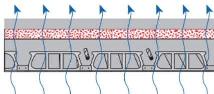
Bild 1b ohne Dampfbremse
