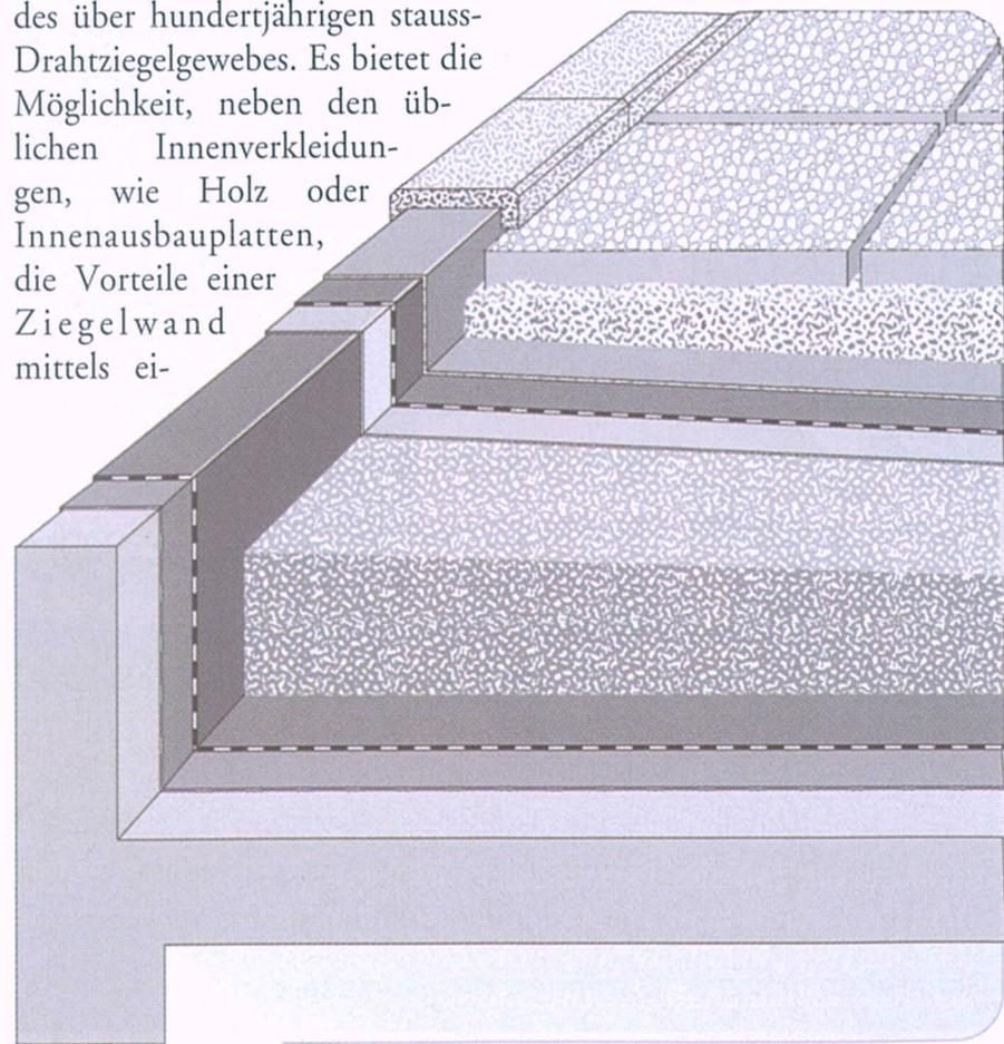
Lattung mit 50 cm Abstand (anstatt den üblichen 40 cm bei Platten) befestigt und anschließend etwa 2 cm stark mineralisch verputzt. Der Vorteil dieser Konstruktion liegt abgesehen vom beeindruckenden Brandschutz (90 Minuten und besser) in der Speichermasse und ihrer ausgleichenden Wirkung bei den Temperaturspitzen.
